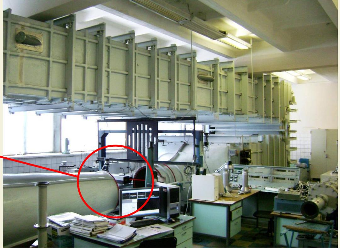
Впервые выполнено оснащение Государственного эталона воздушного потока России специально разработанным прецизионным лазерным диагностическим комплексом «ЛАД-015».
