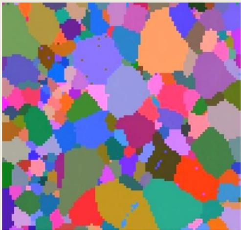
После РТ (1100 °С) обработки средний размер зерна возрастает с ~1 до 10 мкм, ориентация зерен - произвольная
