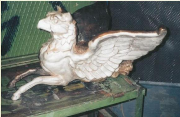
Узел напыления пистолетного типа и скульптурная композиция с покрытием никеля, нанесенным таким "пистолетом"
