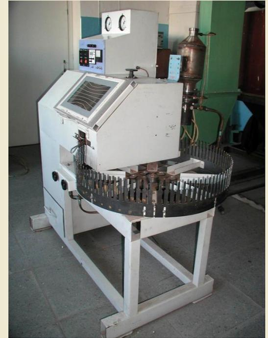
Установка для нанесения покрытий на кабельные наконечники
