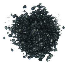
Скорлупа кедрового ореха отмытые (Совместный пиролиз и активация водой)
