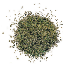
Буроугольный сорбент БУС-502 зерновый (установка псевдоожиженного слоя)
