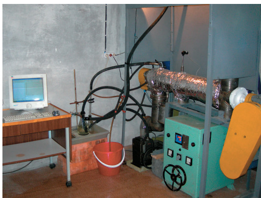
Опытная установка для термолиза угля
