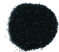
Уголь сапропелитовый (Совместный пиролиз и активация водой)
