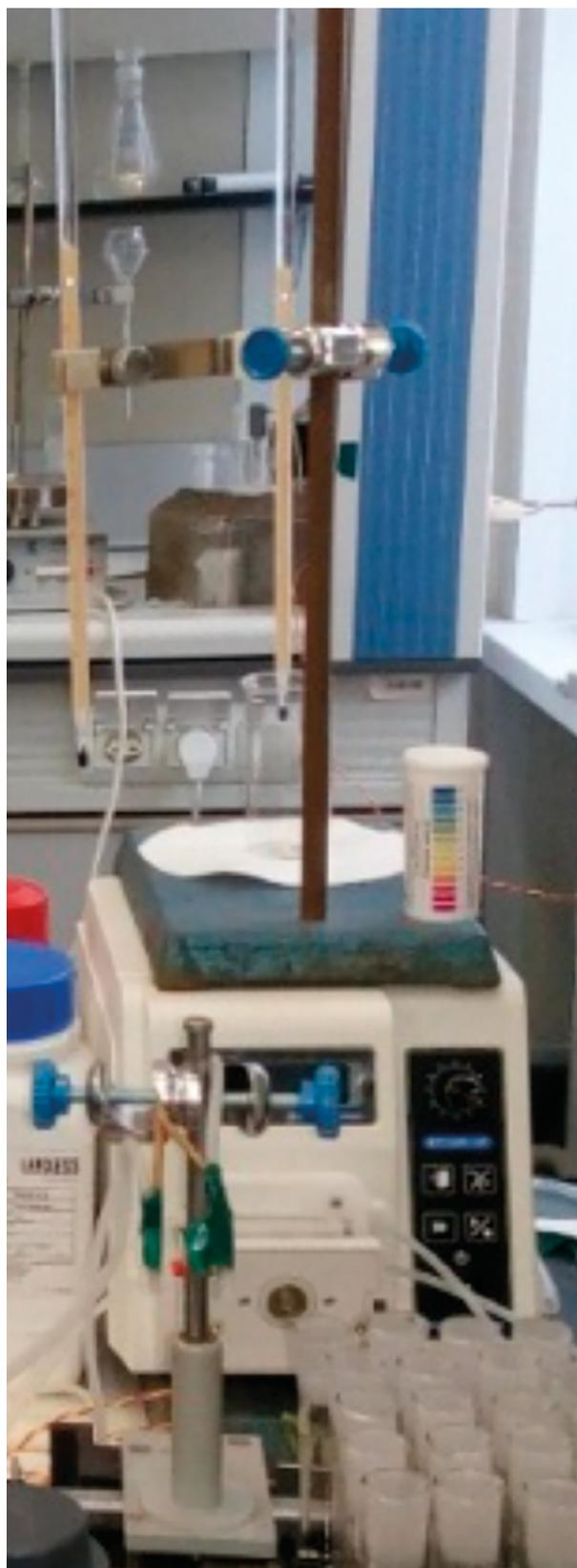
Рис. 1. Хроматографическая установка, используемая для производства  $^{177}\text{Lu}$ .
