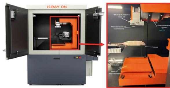
**Рис. 1.** Облучатель с визуальным контролем SmART +.
