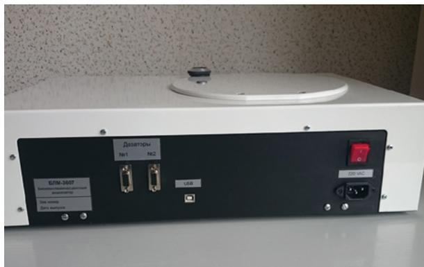
**Рис. 2.** Задняя панель биохемилюминесцентного анализатора БЛМ 3607.
