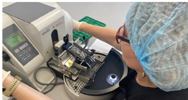
Рис. 4. Генетический секвенатор MiSeq Illumina.
