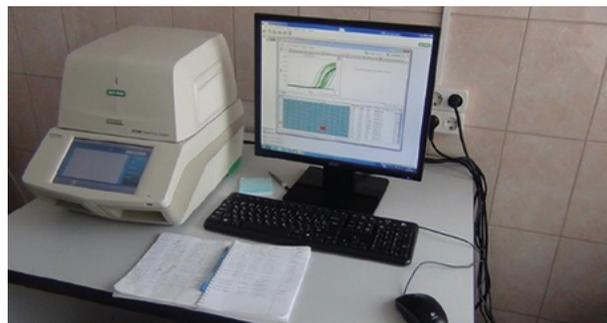
**Рис. 6.** Термоциклер для амплификации нуклеиновых кислот CFX96 Touch, с помощью которого методом ПЦР в режиме реального времени были определены полиморфные варианты гена *MDR1*.
