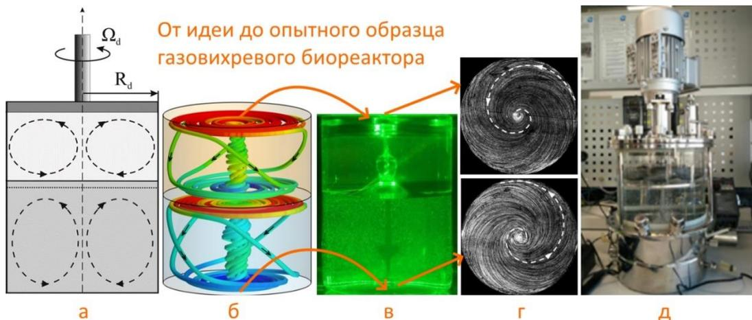
«Вихревое домино» в закрученном потоке двух несмешивающихся жидкостей: а – схема вихревого реактора; б – результаты моделирования; в – экспериментальная визуализация одновременного распада вихря в нижнем и верхнем слое жидкостей; г – аномальное направление закрутки потока, возникающее за счёт обнаруженного эффекта проскальзывания; д – газовихревой биореактор, изготовленный по заказу биотехнологической компании.
