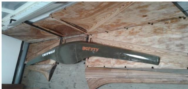
Сверхпрочный корпус, пресс-формы для изготовления БПЛА
