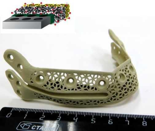
Индивидуальный имплантат из титана для реконструкции нижней челюсти с композитным функционализированным покрытием
