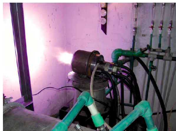
Рис. 6. Испытания плазмотрона. Нарботанный ресурс катода при мощности плазмотрона 90 кВт составил более 900 ч.
