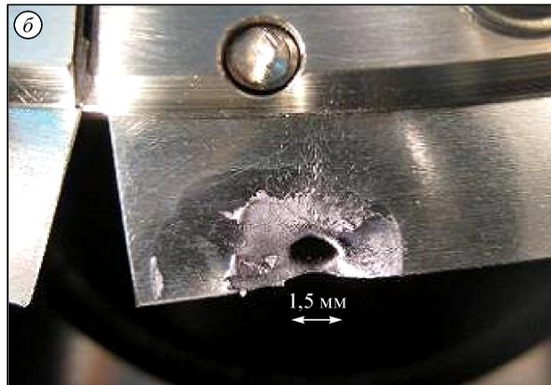
**Рис. 46.** Фотография инжектора ЛИУ (вид со стороны мишени) (а) и фотография отпечатка пучка на танталовой мишени толщиной 0,4 мм при энергии 1,7 МэВ и токе 1,7 кА (б).
