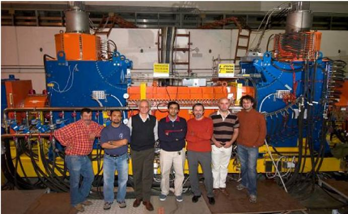
**Рис. 44.** Электронный охладитель в кольце LEIR для накопления ионов свинца.
