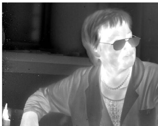
**Рис. 3.** Гистограмма разности температур, эквивалентной шуму фотоприемника  $640 \times 512$  элементов, и пример теплового изображения, полученного с его помощью в составе макета тепловизионного канала.
