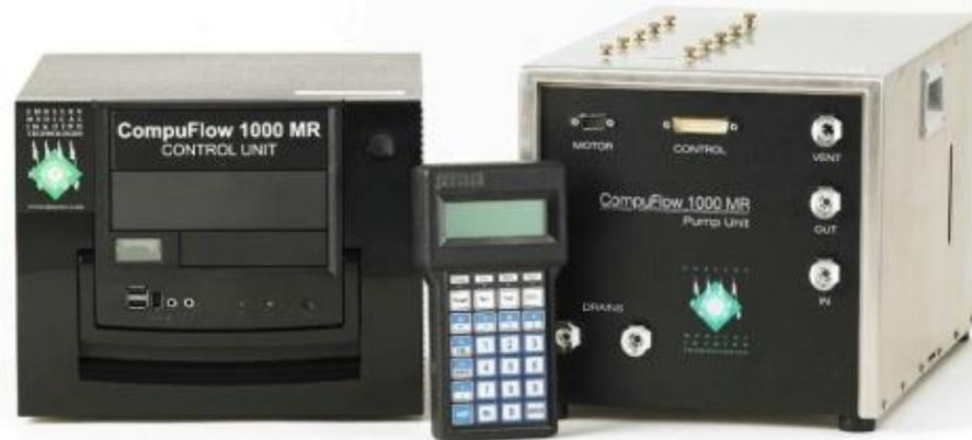
Единственное в России специализированное оборудование для проведения модельных экспериментов – насос-помпа (CompuFlow 1000 MR, Shelley Medical Imaging Technologies), с помощью которого можно создавать различные профили потока жидкости, максимально точно имитирующие движение крови в норме и при патологии в диапазоне объемных скоростей: 0,1 - 35 мл/сек.
