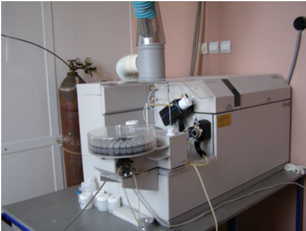
Фотография 3 Квадрупольный масс-спектрометр с индуктивно-связанной плазмой Agilent 7500, США . Современный комплекс определения концентраций элементов (от Be до U) с высокой чувствительностью в воде и почве. Обеспечивает проведение детальных экологических исследований природных систем.
