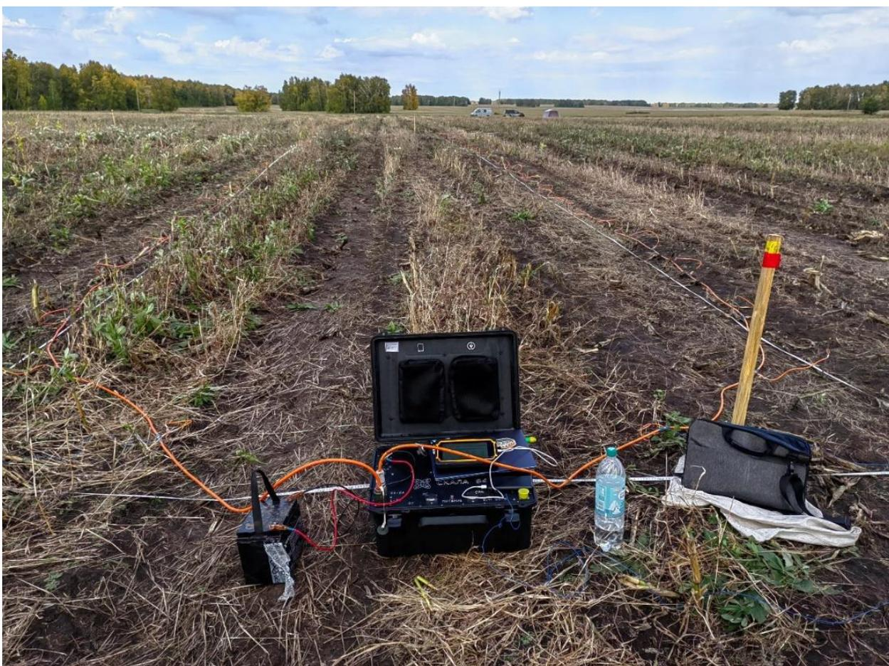
Для измерений геофизики использовали приборы, разработанные в ИНГГ СО РАН – аппаратуру для малоглубинного ЭМК «Геовизер», а также две многоэлектродные электроразведочные станции «Скала». Анализ данных производился при помощи специализированного программного обеспечения.
