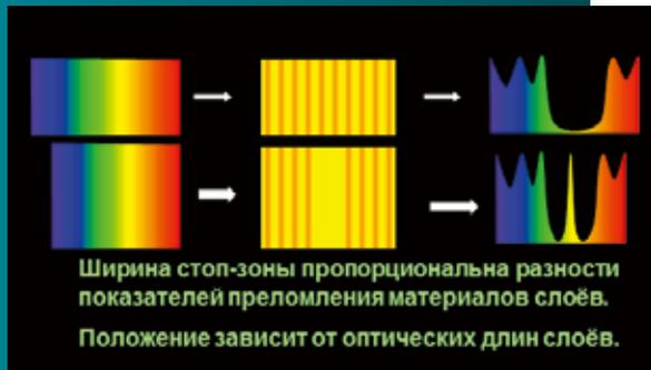
Схематическое представление слоистой структуры из изотропных материалов с показателями преломления  $n_1$  и  $n_2$ , и толщинами  $d_1$  и  $d_2$
