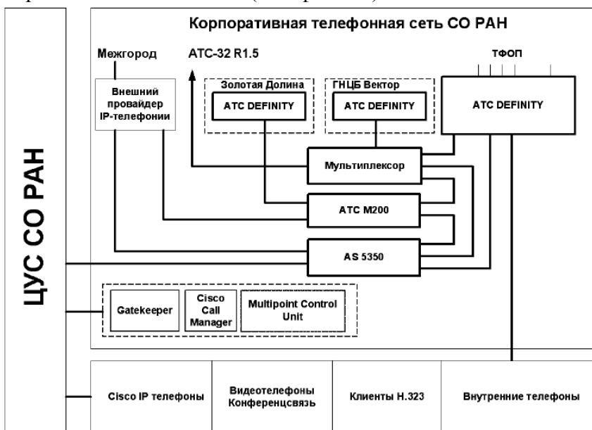
Рисунок 11. Структурная схема ядра КТС СО РАН
