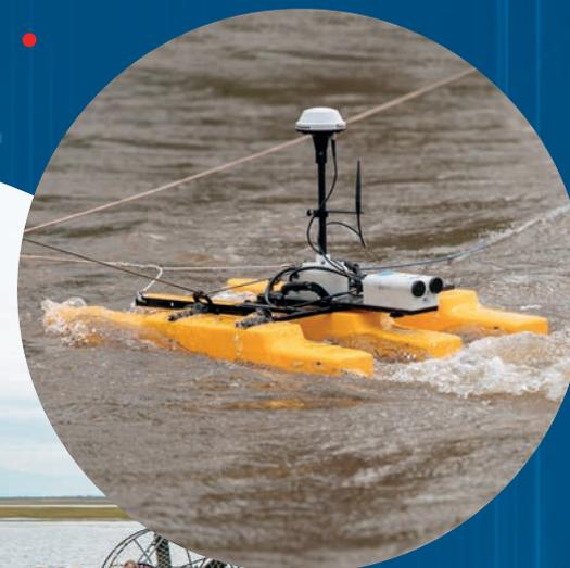
Замер гидрологических параметров с применением автоматической беспилотной платформы
