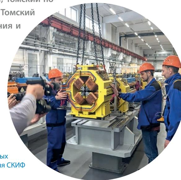
Компоновка магнитных элементов накопителя СКИФ
