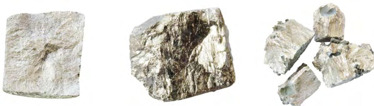
Рис. 6. Образцы ферросилиция от плавки с золой 10 %, 20 %, 30 % на марку ФС65.
