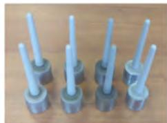
WC/CoCr - пуансоны формовки
