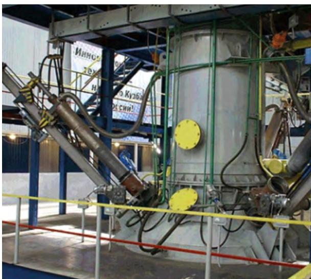
Рис. 1. Плазменная руднотермическая шахтная электропечь для реализации «зеленой» электротехнологии производства металлов и сплавов
