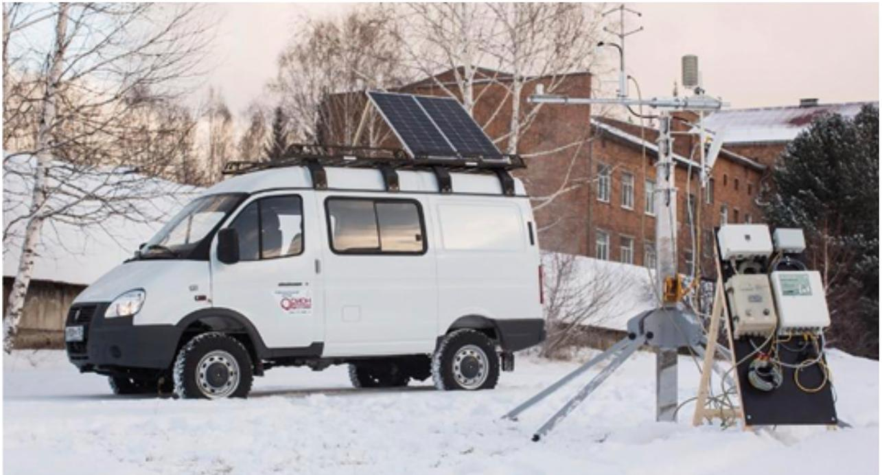
**Рис. 1.** Схема (а) и внешний вид (б) мобильной обсерватории на базе АТС (ГАЗ-27527) для маршрутного мониторинга обменных потоков  $\text{CO}_2$  в экосистемах
