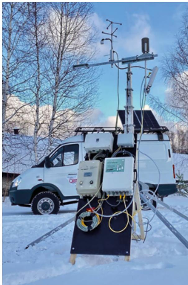
**Рис. 2.** Мобильная обсерватория с развернутой мачтой и комплектами газоаналитического, метеорологического и периферийного оборудования
