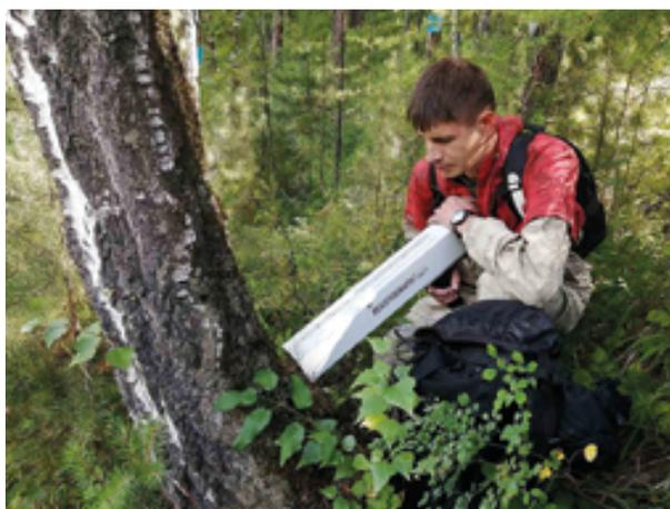
**Рис. 2.** Определение скрытых гнилей в дереве с помощью резистографа
