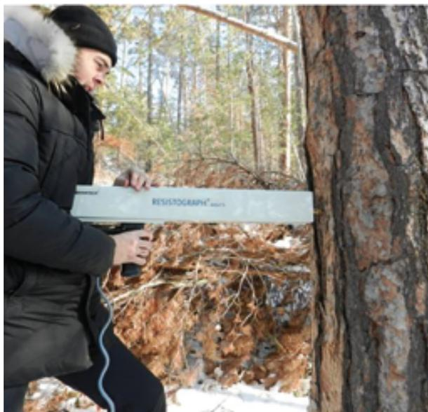
**Рис. 1.** Пример проведения измерения с использованием Resistograph®
