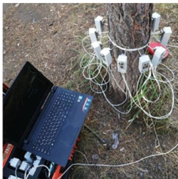
**Рис. 3.** Пример проведения измерения с использованием прибора Arbotom®
