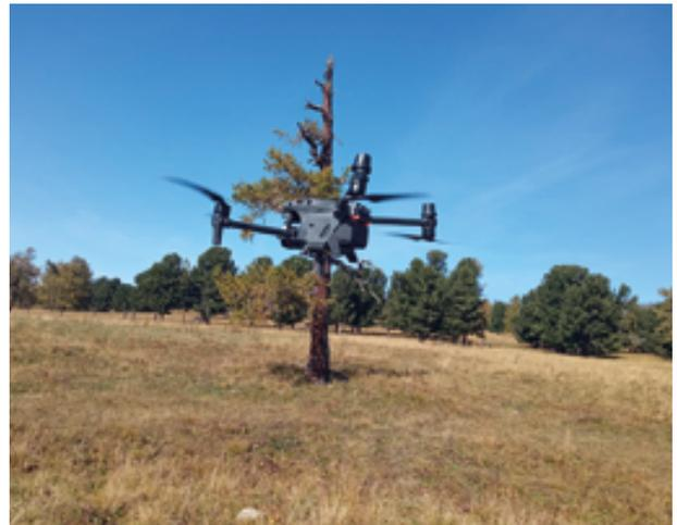
Рис. 8. БВС мультироторного типа DJI Matrice 30t
