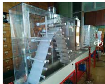
Опытная установка для нанесения защитного слоя на материал
