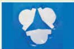
Створки клапана, вырезанные на лазерной установке
