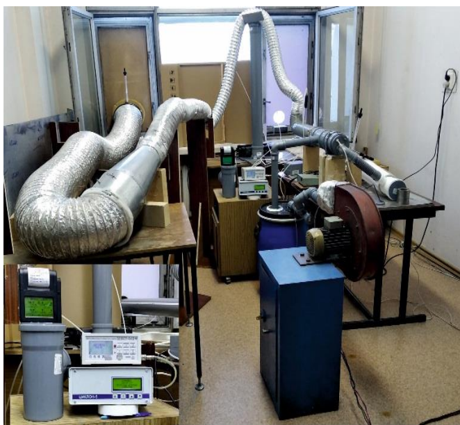
Устройство для дезодорации и нейтрализации вентиляционных выбросов производственных помещений
