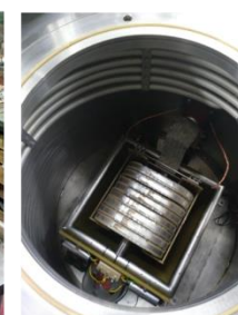
Импульсный трансформатор модулятора
