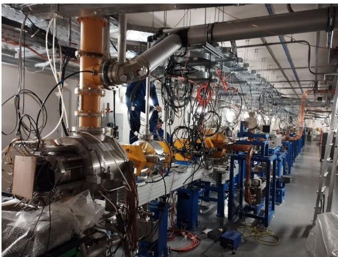
Собранный линейный ускоритель инжектора ЦКП «СКИФ»
