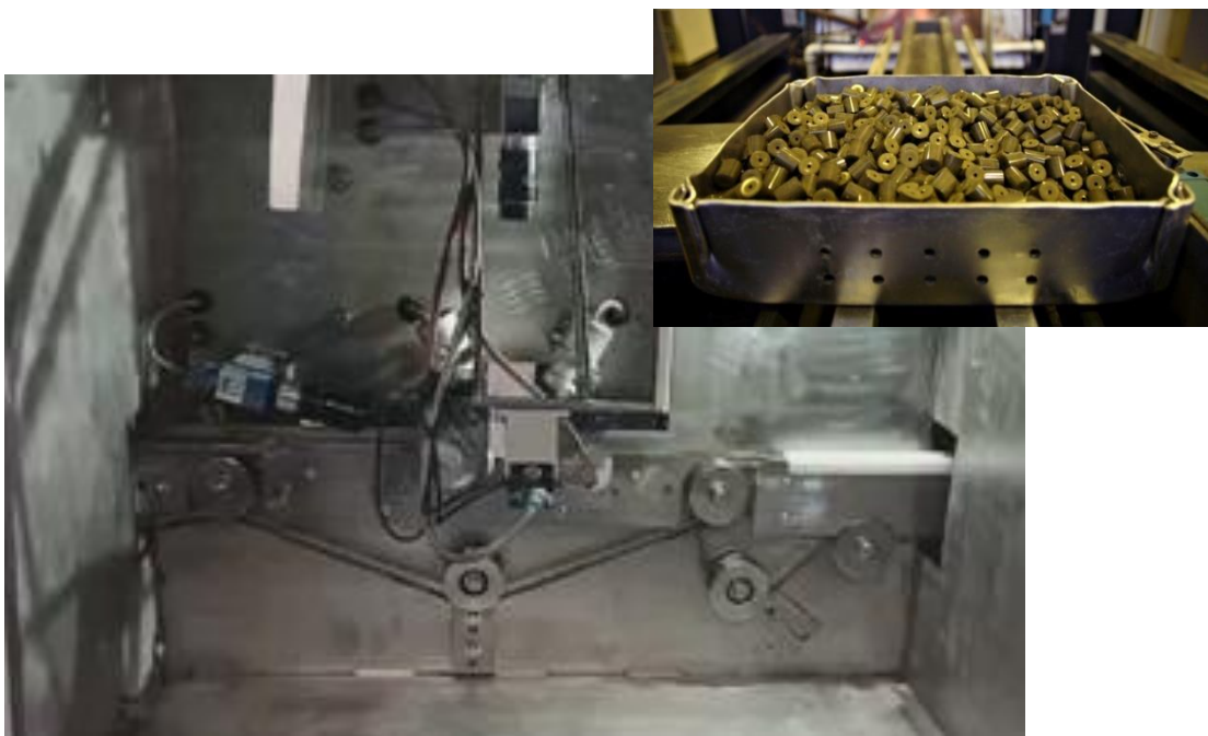
Узел контроля внешнего вида топливных таблеток на линии автоматизированного контроля (снизу), вид урановых таблеток перед обжигом в печи (сверху)
