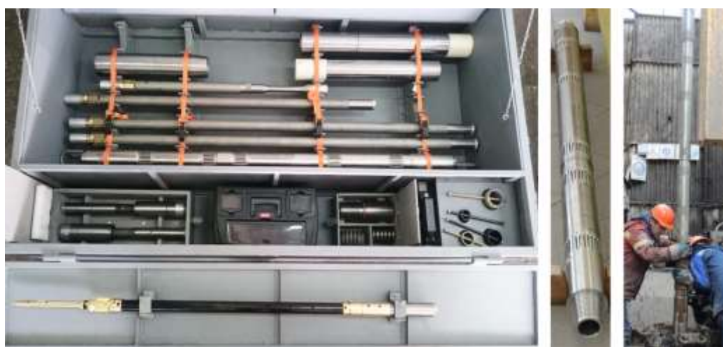
Рисунок 39 – первая отечественная телеметрическая система каротажа в процессе бурения
