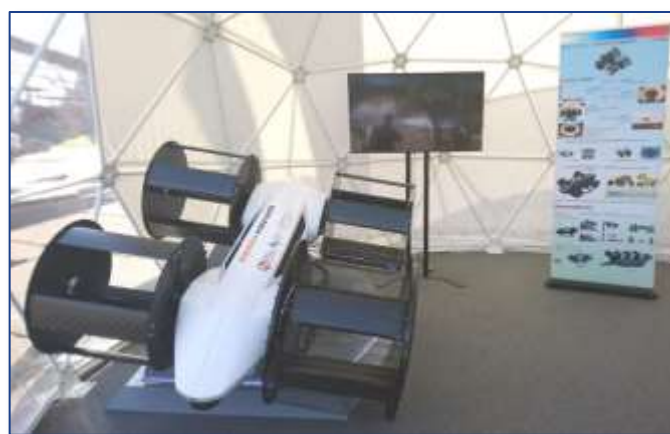
Рисунок 76 – Беспилотный летательный аппарат (БПЛА) проекта «Циклон» способен транспортировать до 20 килограммов (совместная разработка ИТ СО РАН с Фондом перспективных исследований и научно-производственным предприятием «Автономные аэрокосмические системы»)
