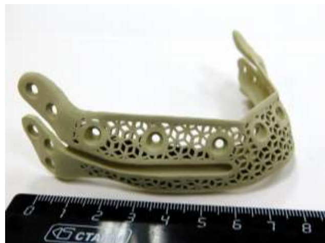
Рисунок 14 – индивидуальный имплантат из титана для реконструкции нижней челюсти с композитным функционализированным покрытием
