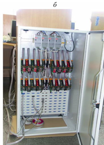
Рис. 26. Измерительные датчики (а) и стойка питания и связи с датчиками (б) цехового комплекса контроля.
