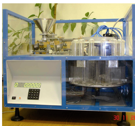
Рис. 25. Общий вид автомата сортировки алмазов.
