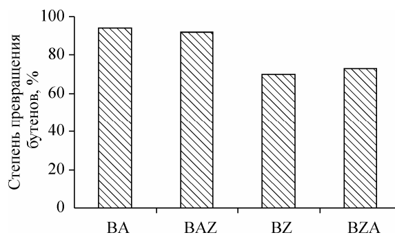
Рис. 5. Сравнение активностей катализаторов олигомеризации легких алкенов на основе боратсодержащих оксидов алюминия и циркония и их композиций.
