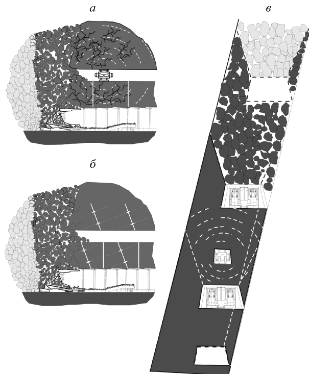
Рис. 29. Система подэтажного обрушения с механизированным выпуском угля.
