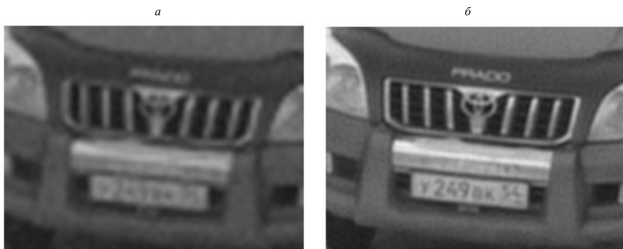
Рис. 3. Одно из исходных изображений низкого разрешения ( a ) и изображение с трехкратно повышенным разрешением (по серии из 25 изображений) ( б ).
