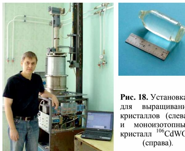
Рис. 18. Установка для выращивания кристаллов (слева) и моноизотопный кристалл  $^{106}\text{CdWO}_4$  (справа).
