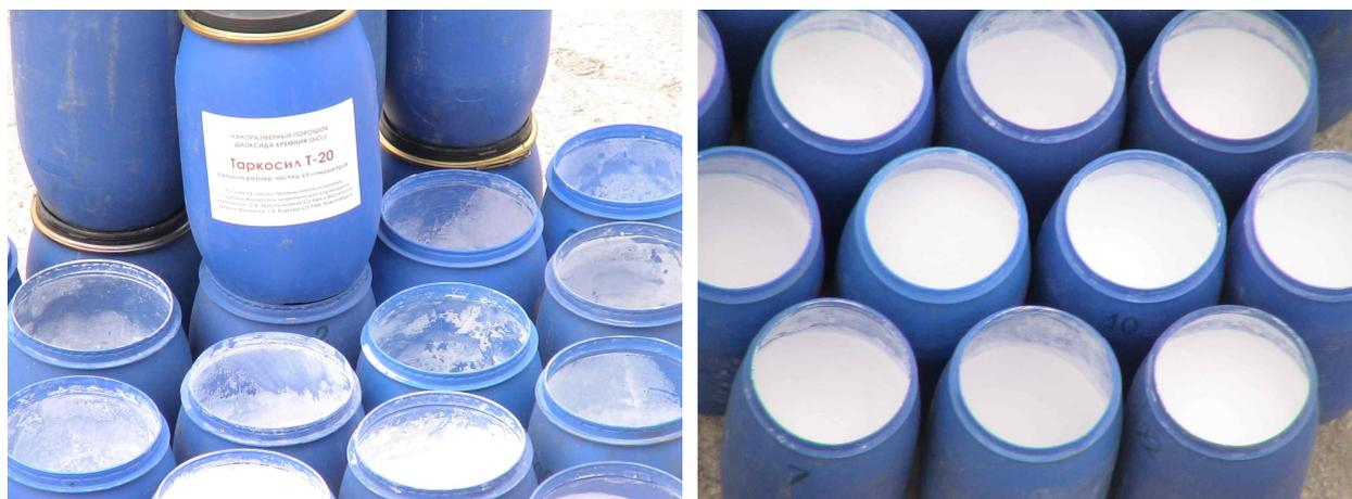
Рис. 9. Бочки с нанопорошками диоксида кремния, произведенные на пилотной установке, средний размер частиц 15—60 нанометров.
