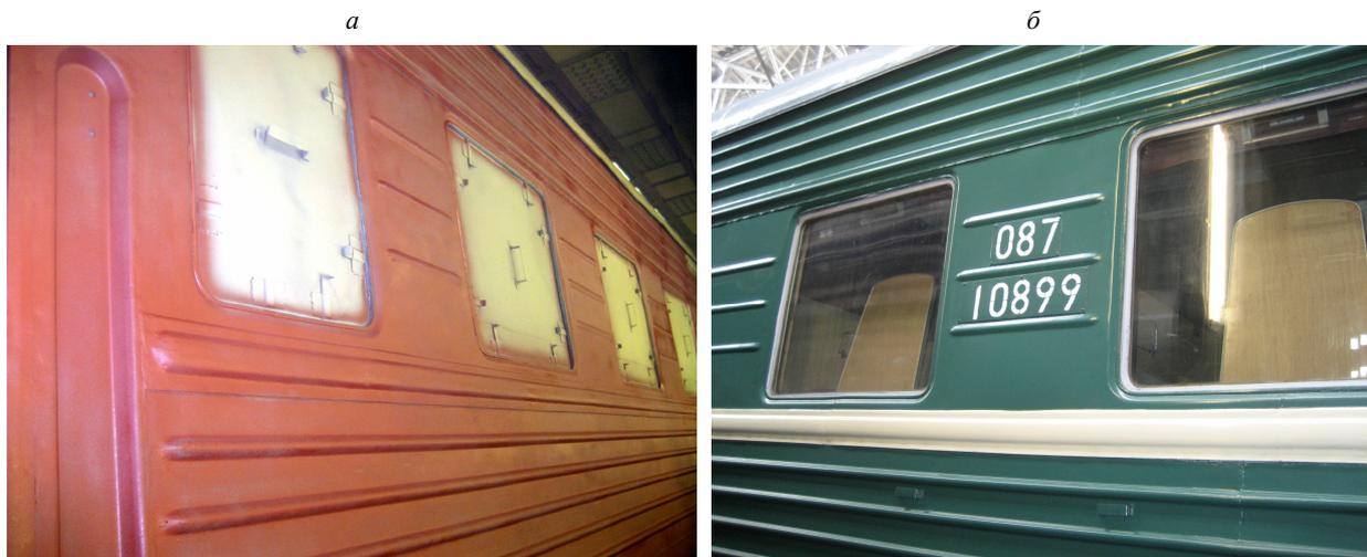
**Рис. 10.** Защитное грунтование (а) и декоративное окрашивание (б) кузова вагона с помощью ЛКМ, модифицированных нанопорошками диоксида кремния.
