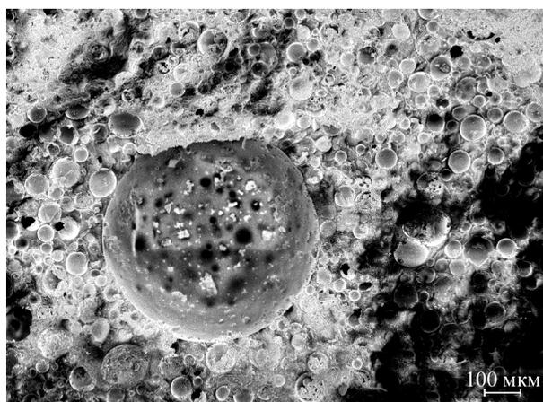
Рис. 37. Микроструктура сферопласта.
