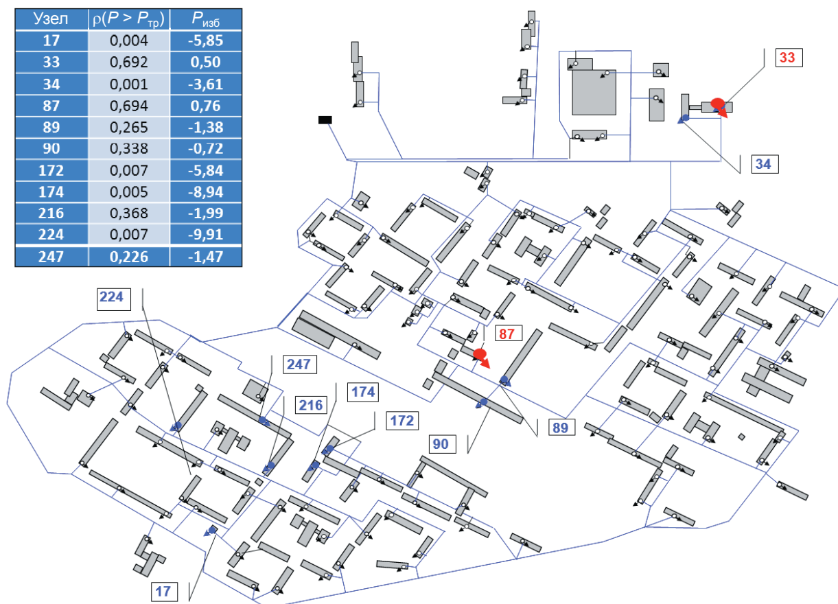
Рис. 2. Вероятностный анализ потокораспределения и обеспеченности потребителей водопроводной сети м-на Солнечный г. Иркутск в час максимального водопотребления.
