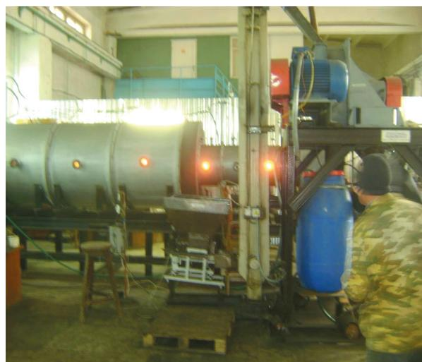
**Рис. 5.** Стенд с тепловой мощностью до 5 МВт.
