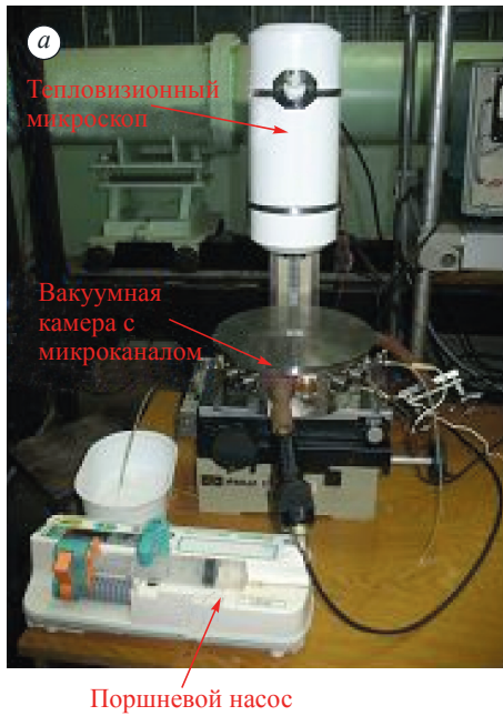
Рис. 31. Измерительный комплекс (а) и результаты измерений теплоотдачи для суспензии наночастиц диоксида кремния в этиловом спирте (б).
