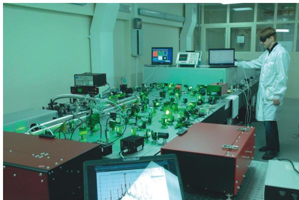
**Рис. 14.** Фемтосекундная лазерная система с оптическими параметрическими каскадами усиления чирпованных импульсов и пикосекундным источником излучения накачки.
