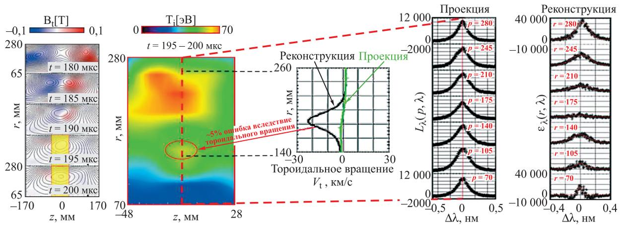
**Рис. 2.** Реконструкция двумерного распределения ионной температуры по результатам спектральных (доплеровских) измерений.
