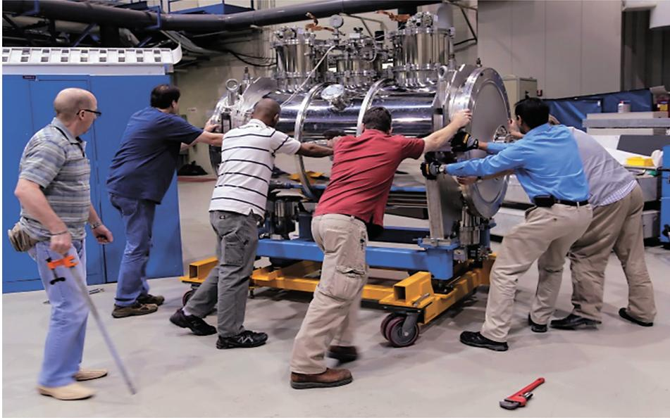
**Рис. 55.** Сверхпроводящий 15-полюсный вигглер с полем 7,5 Тл и периодом 200 мм во время установки в центре синхротронного излучения LSU CAMD в США.
