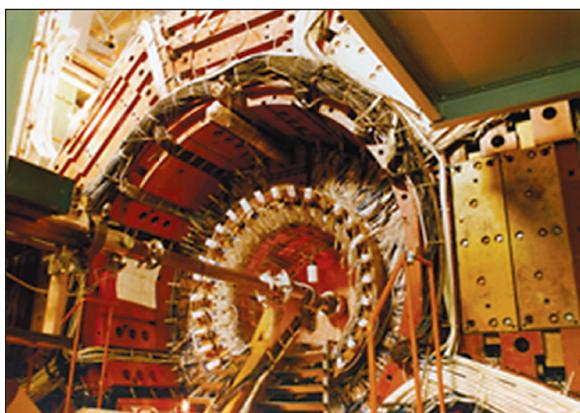
Рис. 42. Детектор КЕДР в частично разобранном состоянии.
