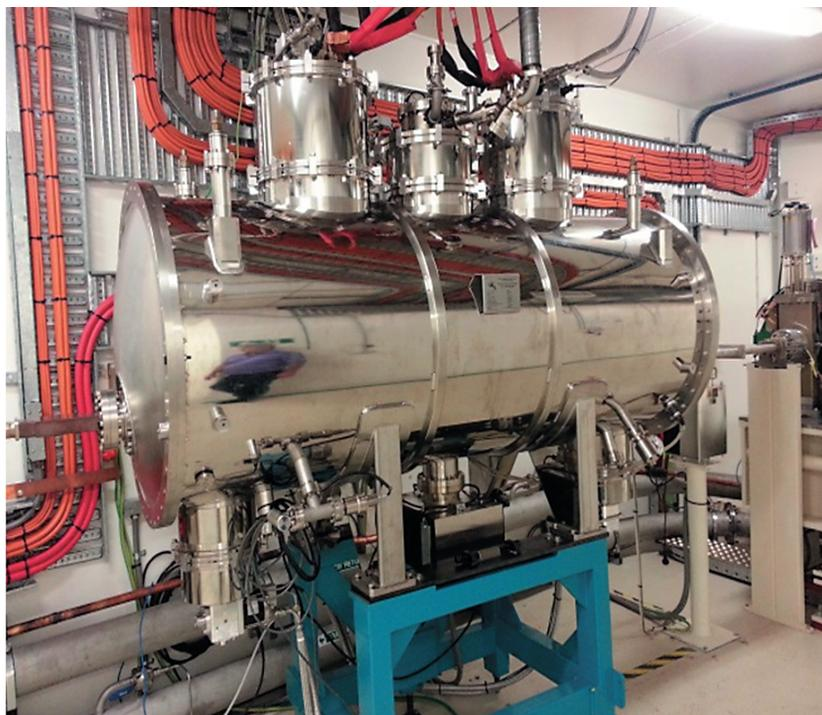
**Рис. 54.** Сверхпроводящий 63-полюсный вигглер с рабочим полем 4,2 Тл с периодом поля 48 мм был разработан и изготовлен для австралийского синхротрона (ASHo).
