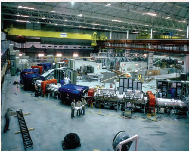
Рис. 3. Накопитель (аккумулятор) антипротонов, использующий метод стохастического охлаждения Симона ван дер Меера ( http://astronu.jinr.ru/school/arhiv/shkola-2014/shlippe-prezentaciya )
