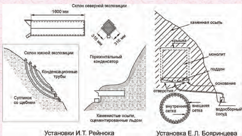
Рис. 4. Установки для сбора конденсационной влаги конструкций И. Т. Рейнюка [3] и Е. Л. Бояринцева [8] по их оригинальным рисункам
