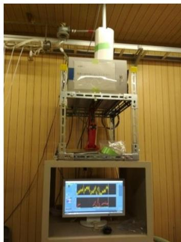
Автоматический анализатор элементного состава аэрозоля
