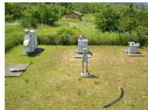
Автоматическая станция пробоотбора газов, аэрозоля, атмосферных осадков
