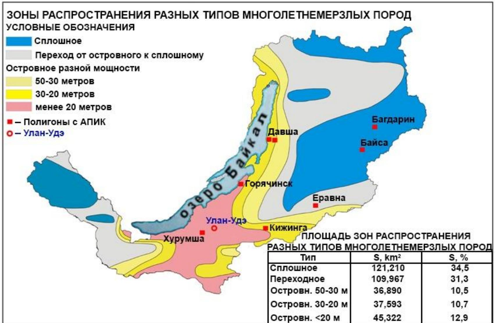
Карта распространения типов многолетней мерзлоты и схема расположения полигонов АПИК
