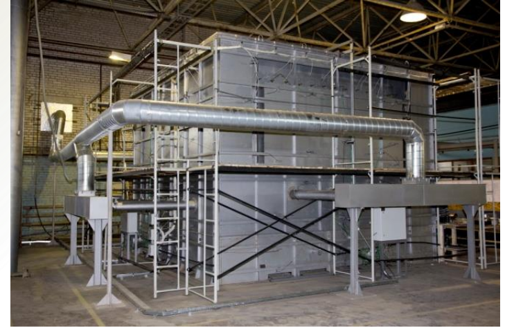
Комплекс уникальных стенов для моделирования теплофизических процессов в элементах ядерных реакторных установок
