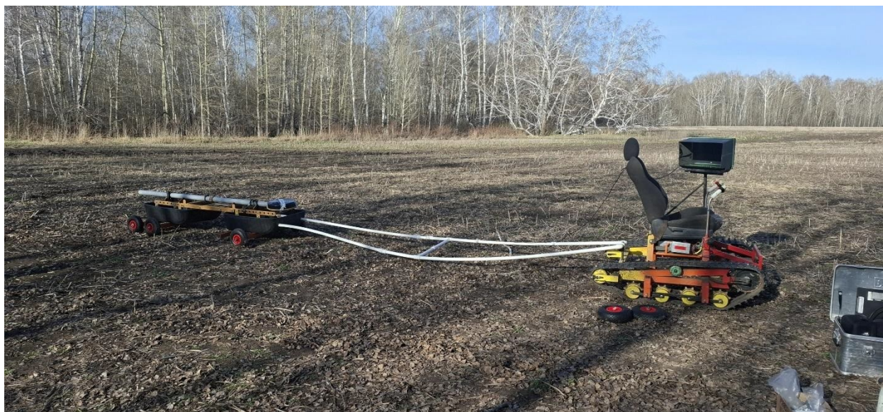
Аппаратура электромагнитного профилирования ЭМС, буксируемая гусеничным транспортером
