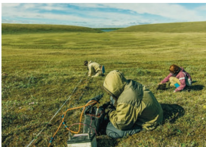
Полевая геофизическая съёмка методом электротомографии и отбор почвенных образцов
