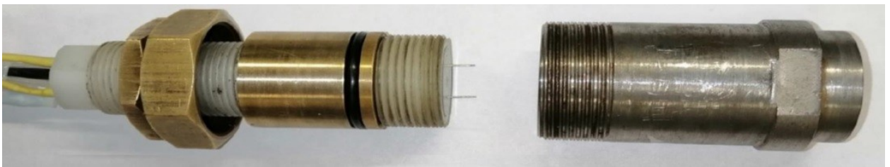
Датчик измерителя сопротивления в разобранном виде. Справа – стальной стакан измерительной ячейки, торцевая часть которого предназначена для вваривания в трубу продуктопровода.
