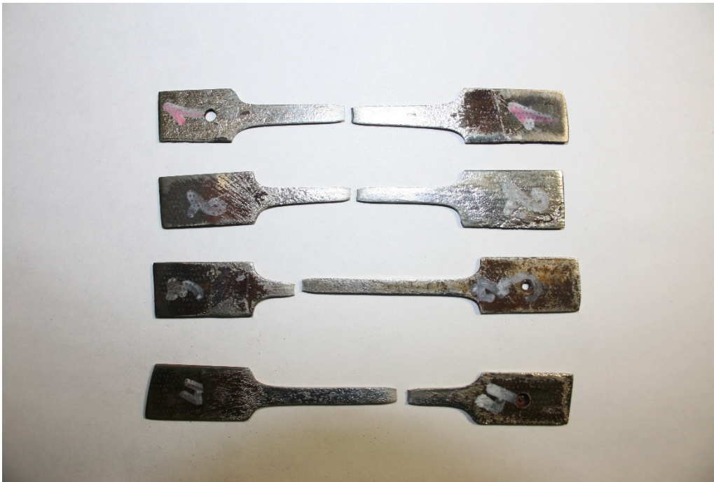
Образцы, выплавленные из железной руды, добытой в рудопроявлении Кэнтик Верхне-Вилуйского района Республики Саха (Якутия) после испытаний на одноосное растяжение
