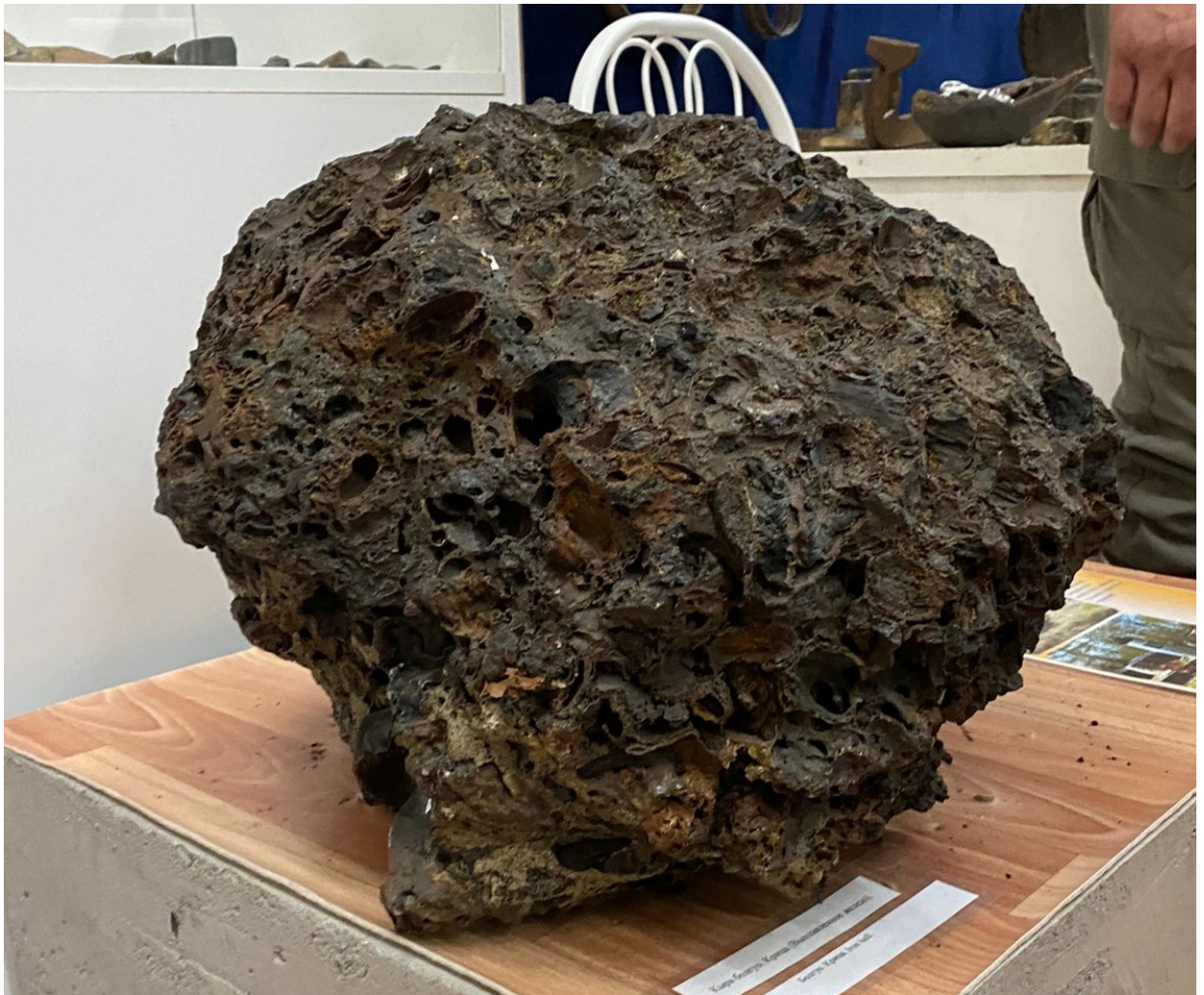
Крица — ком выплавленной железной руды из месторождений Республики Саха (Якутия)
