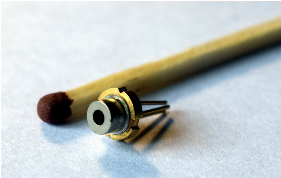
3. Лазер с вертикальным резонатором в корпусе. Рядом спичка для масштаба. Фото предоставлено Владимиром Гайслером
