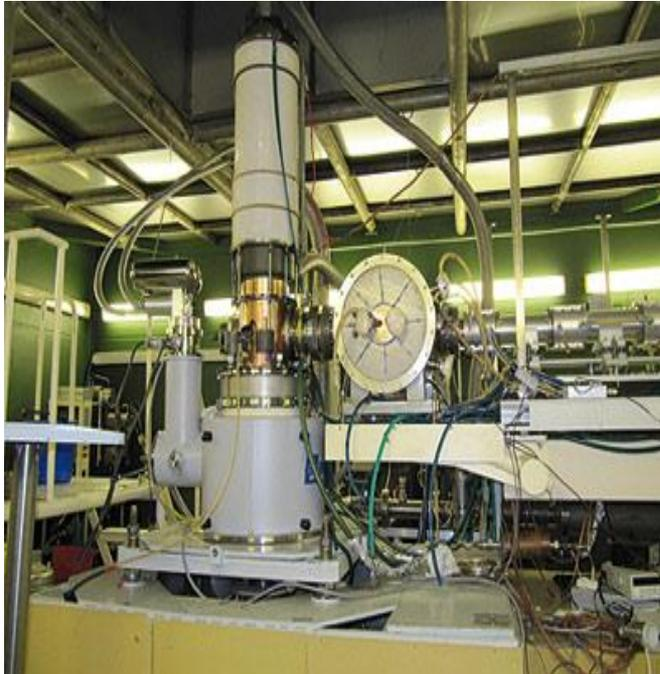
Стенд испытаний гиротронов для проекта ITER
