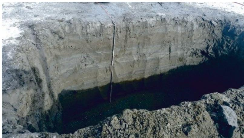
*Разрез шурфа, из которого были отобраны образцы отходов для анализа*
