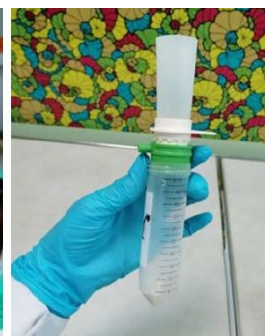
Лабораторная обработка образцов для палинологического анализа: взвешивание образцов перед лабораторной обработкой; центрифугирование образцов; обработка образца соляной кислотой для удаления карбонатов; ситование образца через сито 150 мкм
