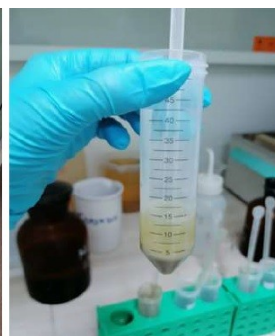
Лабораторная обработка образцов для палинологического анализа: взвешивание образцов перед лабораторной обработкой; центрифугирование образцов; обработка образца соляной кислотой для удаления карбонатов; ситование образца через сито 150 мкм
