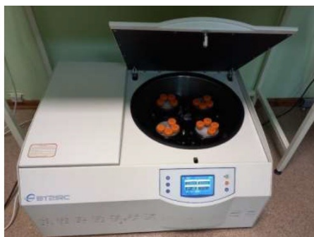
Лабораторная обработка образцов для палинологического анализа: взвешивание образцов перед лабораторной обработкой; центрифугирование образцов; обработка образца соляной кислотой для удаления карбонатов; ситование образца через сито 150 мкм
