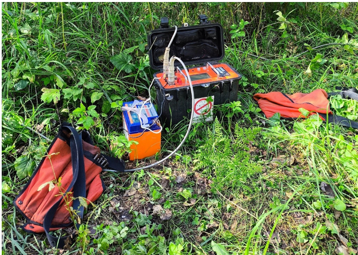
Измерение по профилю мониторинга многоэлектродной электроразведочной аппаратурой «Скала 48»
