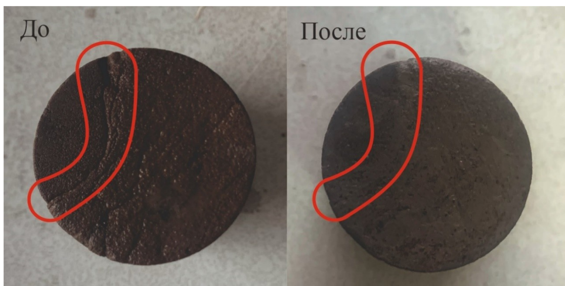
Заполнение пор и трещин на образце глинистыми частицами в процессе эксперимента
